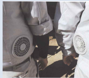
空調機能付きの作業服の活用
